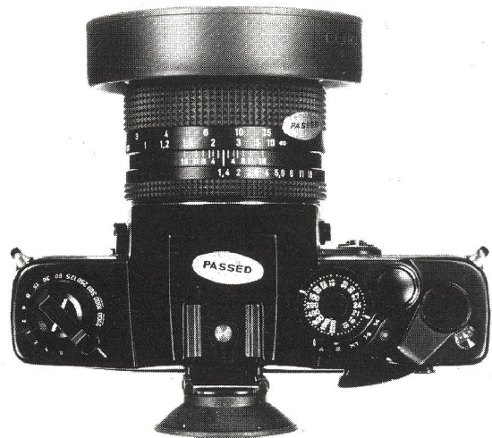
Fra højre ses filmfremtræk, microswitch-udløser, asaindstilling med automatik-korrektion, hot shoe, samt lukkertidsindstillingen, der alt for let kan skubbes fra automatik til faste tider.
